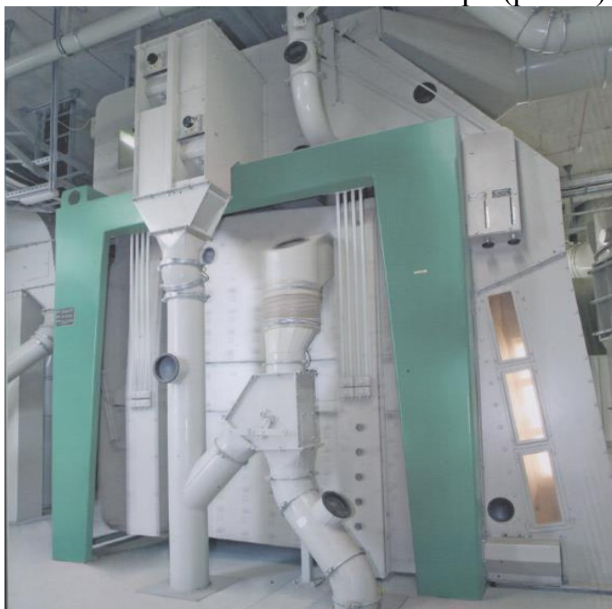
Рисунок 2 – Внешний вид и функциональная схема зерноочищающей машины серии Schmidt-Seeger TAS
