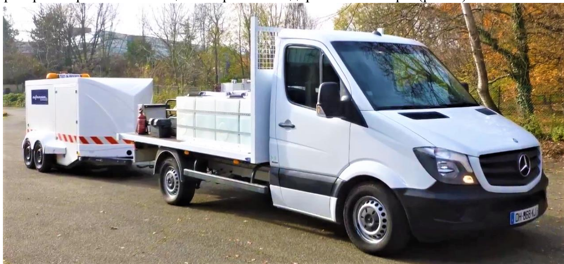
Рисунок 1 – Внешний вид дорожного тестера DUFOURNIER Skid Trailer на базе автомобиля Мерседес-бенц [2]
