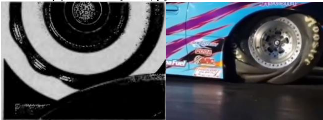
Рисунок 1 – Деформация шины при подведении к колесу крутящего момента и качении колеса с большой скоростью:
