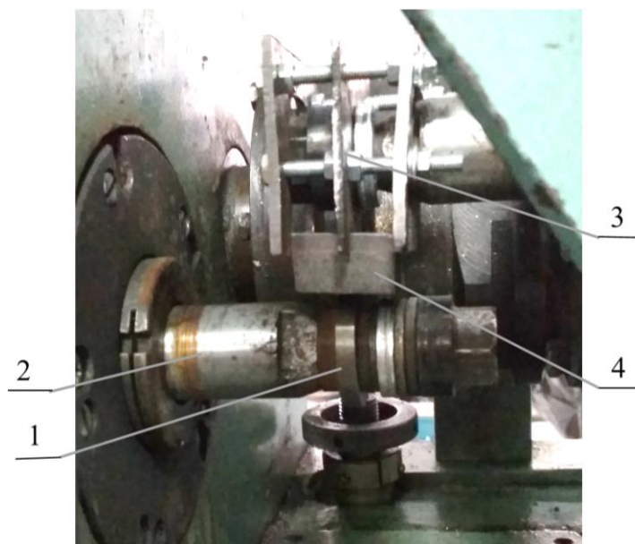
Рисунок 2 – Установка испытательных образцов в машине трения СМЦ-2: 1 – подвижный образец (диск); 2 – вращающийся вал машины трения; 3 – захват; 4 – неподвижный образец (колодка)
